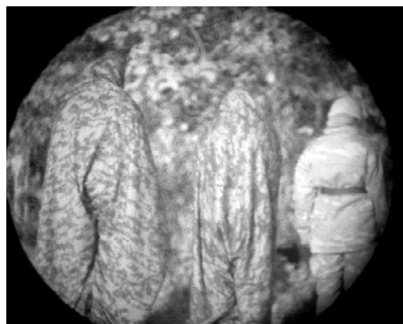
Obrázok 1 Záber z terénneho testovania textílií pre maskovacie účely v nočných podmienkach. Zlava: vývojový model UnIII M3, finálny model UnIII M1, aktuálny odev vz. 97 na listnatom pozadí.
