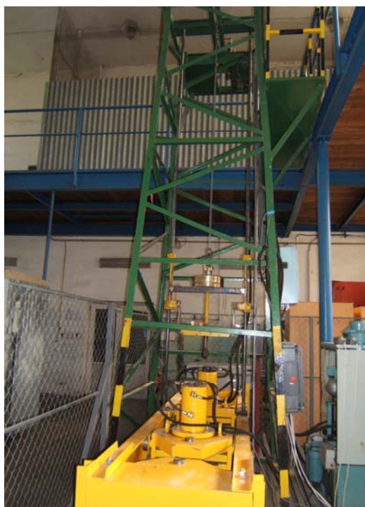
Obr. 1 Skúšobné zariadenie na testovanie odolnosti dopravných pásov proti prierazu
