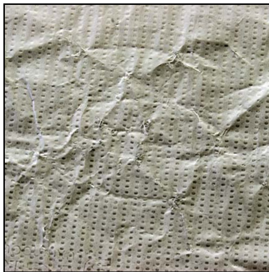
Obr. 2 Poškození vzorku izolační ochranné fólie po namáhání počtem cyklů oděru 3000
